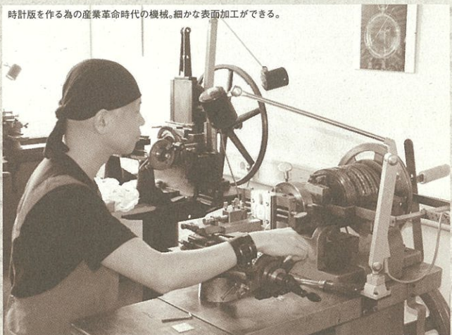
時計版を作る為の産業革命時代の機械。細かな表面加工ができる。
